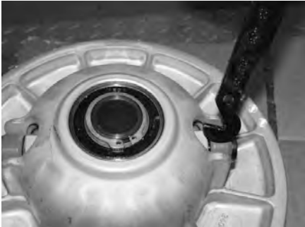
Hakenende des Werkzeugs einführen.
